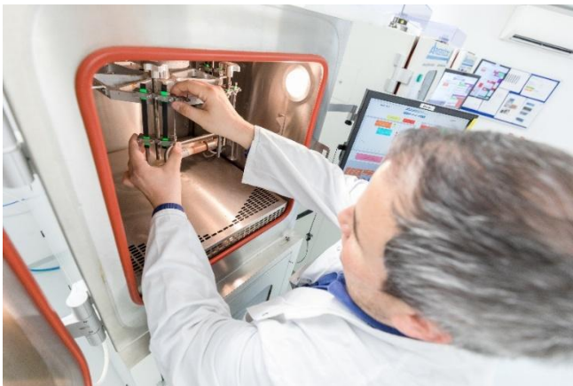
Abb. 2: Einbau der in einer Vorrichtung vorgespannten Probekörper in einen Ozonprüfschrank (Bild: Tobias Ehmer)
