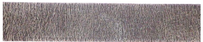
Abb. 4: NBR-Streifenprobe 125 x 10 mm nach Ozonprüfung nach ISO 1431-1A (Konditionierung 48-96h, Prüfzeit 72h, rel. Feuchte max. 65%, Dehnung 20%, Ozonkonzentration 50pphm) (Bild: OPR Group GmbH)
