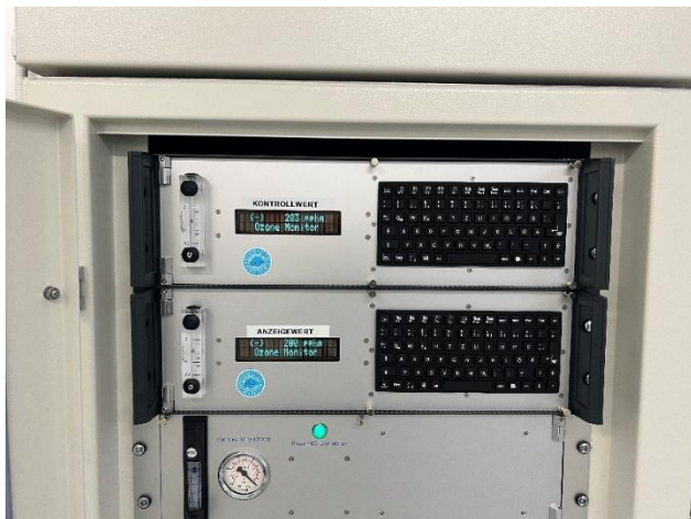
Abb. 3: Um die richtige Ozonkonzentration in der Ozonprüfkammer sicherzustellen, wird diese von zwei unabhängigen Sensoren gemessen, der erste ist für die Regelung verantwortlich, der zweite zur Kontrolle bzw. Überwachung. (Bild: OPR Group GmbH)
