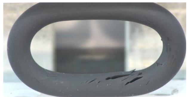
Abb. 5: Die inneren Risse pflanzen sich häufig bis nach außen an die Oberfläche fort (Bild: OPR Elastolabs)
