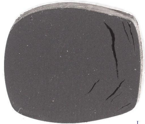
Abb. 3: Innere Risse sind typisch für das Schadensbild der explosiven Dekompression (Bild: OPR Elastolabs)
