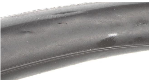
Abb. 2: Sind die Blasen geplatzt, hinterlassen sie kurze Risse in Umfangsrichtung an der Oberfläche (Bild: OPR Elastolabs)
