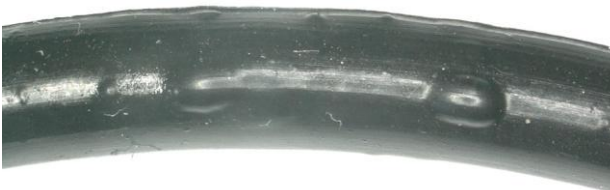
Abb. 1: Blasen an der Oberfläche sind klare Hinweise auf eine Schädigung durch explosive Dekompression (Bild: OPR Elastolabs)
