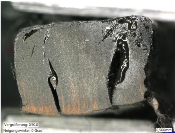
Abb. 7: Innere Risse durch explosive Verdampfung (Bild: OPR Elastolabs)
