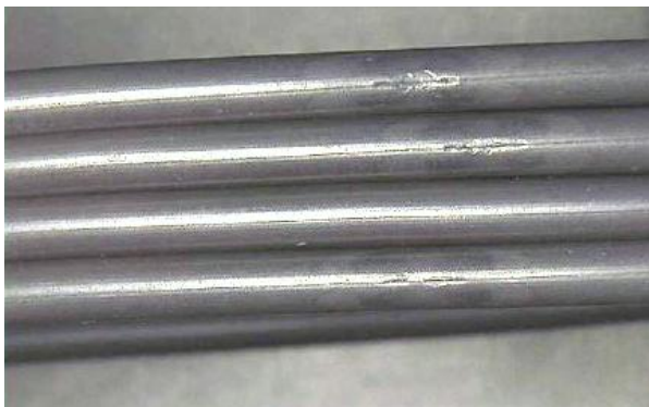
Abb. 2: In manchen Fällen zeigt sich das Backrinding nicht umlaufend, sondern nur im Anschnittbereich der O-Ringe (Bild: OPR Elastolabs)
