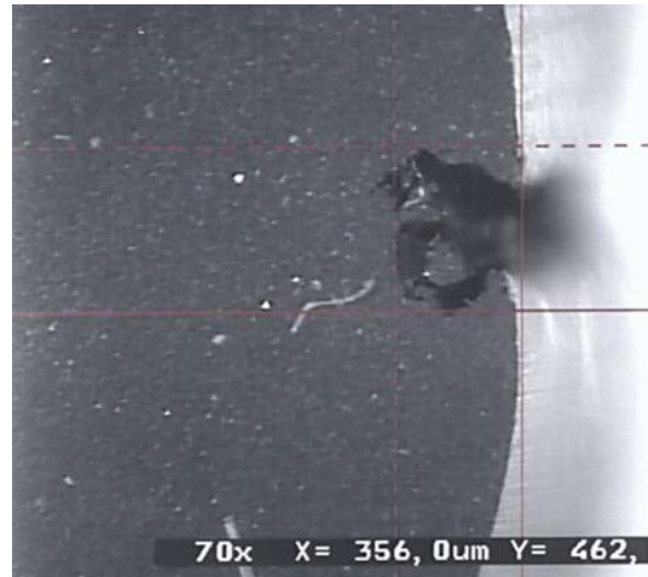
Abb. 4: Querschnitt des O-Rings aus Abb. 3, die U- bzw. W-förmige Einzugsstelle ist unter 70-facher Vergrößerung gut zu erkennen. (Bild: OPR Elastolabs)
