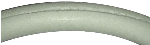
Abb. 1: Schrumpfriss umlaufend entlang der Trennebene eines O-Rings (Bild: OPR Elastolabs)
