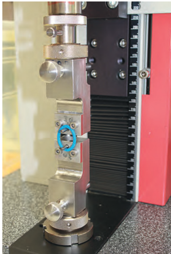
Bild 4: Zugversuch eines kleinen O-Ringes: Wenn der Einsatz von kugelgelagerten Rollen nicht mehr möglich ist, kommen in der Praxis eingeölte feststehende Dorne vor (Bild: O-Ring Prüflabor Richter GmbH)
