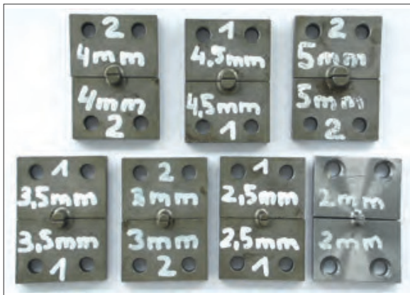
Bild 3: Halbschalen zur reproduzierbaren Prüfung kleiner O-Ring-Durchmesser (Sonderanfertigung) (Bild: O-Ring Prüflabor Richter GmbH)
