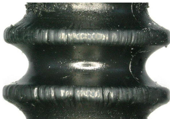
Bild 4: Strömungserosion an einer Dämpferdichtung infolge von Überströmen
