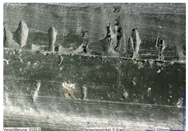
Bild 3: Erosionstrichter als Folge eines dynamisch bedingten Überströmens
