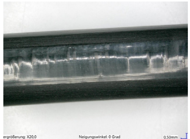
Bild 2: Erosionsriefen aus einer dynamisch bedingten Überströmung, zusätzlich hat die Dichtungsbuchse infolge der Druckstöße durch Axialbewegungen einen leichten Abrieb erzeugt
