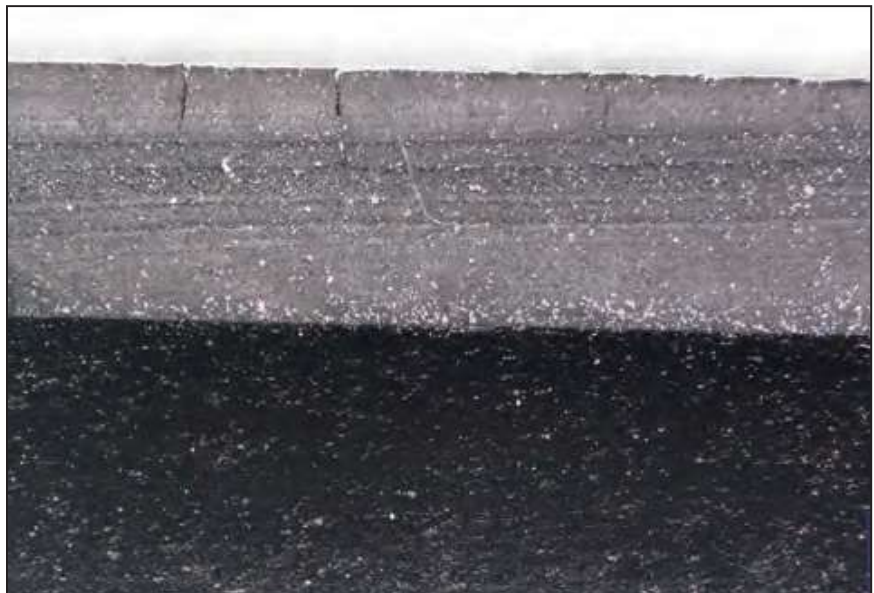
>>6: Profilschnitt der Schlauchwandung, Risse am Außendurchmesser, keine Risse am Innendurchmesser (Medienseite) (Bild: O-Ring Prüflabor Richter GmbH)
