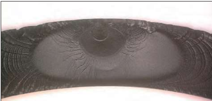
>>3: Bruchfläche des HNBR-O-Rings mit klar erkennbarer kreisförmiger Rissfortpflanzung (Bild: O-Ring Prüflabor Richter GmbH)
