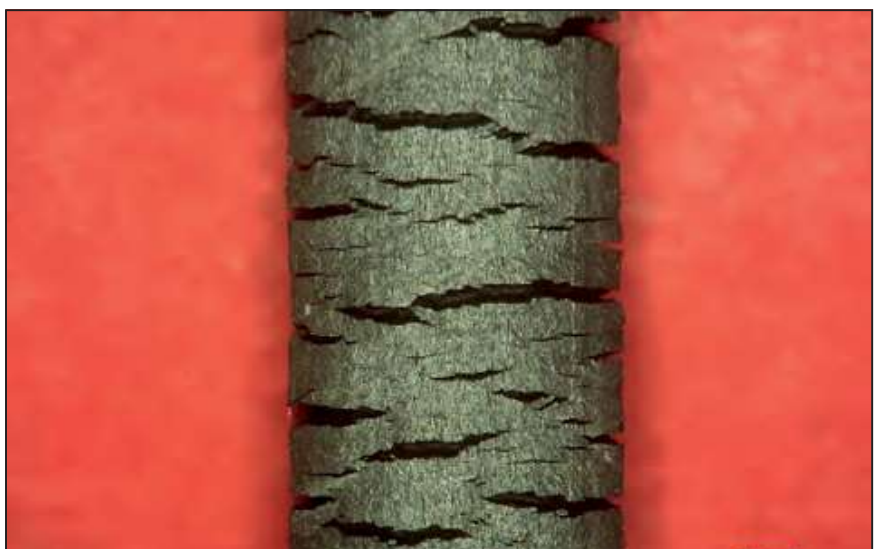
>>7: Risse nach einer Ozonprüfung an einem Abschnitt eines neuen Referenzmusters (Serienzustand) (Bild: O-Ring Prüflabor Richter GmbH)
