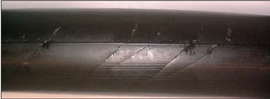
>>2: Risse am Außendurchmesser eines HNBR-O-Rings (Bild: O-Ring Prüflabor Richter GmbH)
