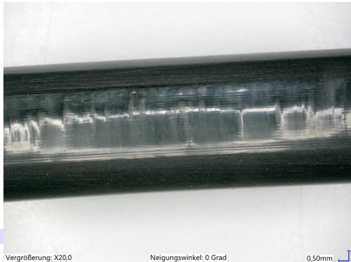
Abb. 4: Erosionsriefen aus einer dynamisch bedingten Überströmung, zusätzlich hat die Dichtungsbuchse infolge der Druckstöße durch Axialbewegungen einen leichten Abrieb erzeugt
