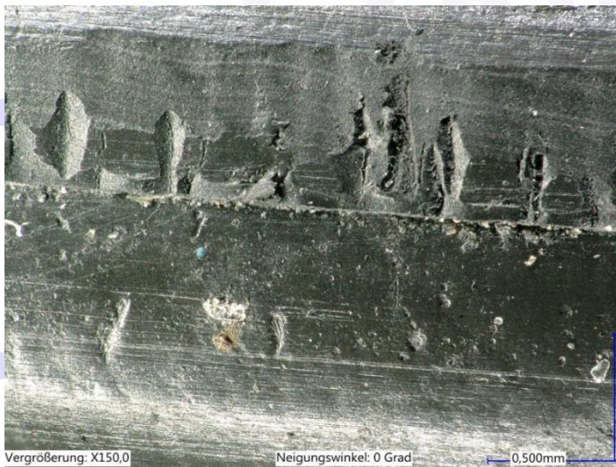
Abb. 5: Erosionstrichter als Folge eines dynamisch bedingten Überströmens
