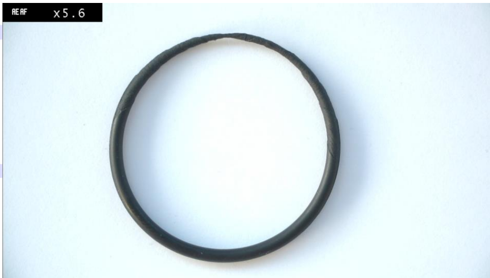
Abb. 8: O-Ring nach Spaltextrusion wegen zu großem Spaltmaß: Der Bereich mit der geringsten verbliebenen Schnurstärke (oben im Bild) stellt den Beginn der Spaltextrusion dar und ist die Stelle am Umfang mit dem größten Spaltmaß zwischen Kolben und Zylinder
