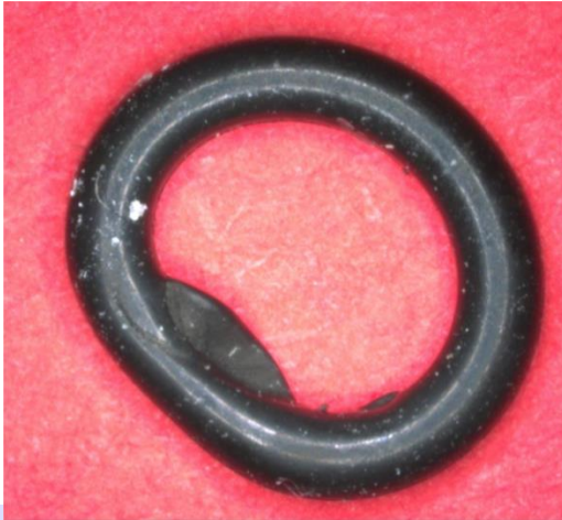
Abb. 16: Schaden durch einen Montagefehler (Abquetschung)
