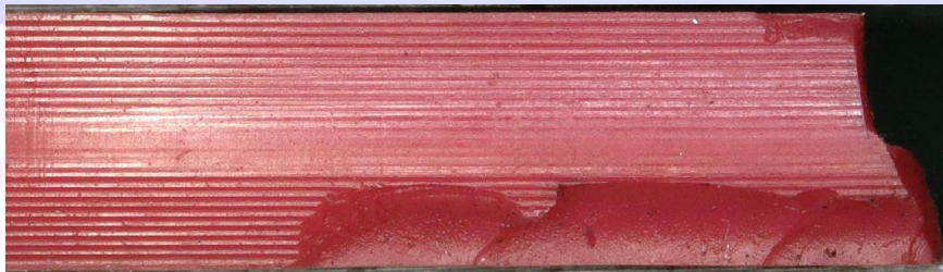
Abb. 13: Beschädigung einer Thermoplastischen Polyurethandichtung am Dichtspalt nach starker chemischer Einwirkung und daraus resultierendem Festigkeitsabfall.
