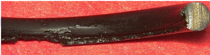
Abb. 17: Schadensbild Luft im Hydrauliköl, die Schädigung findet sich im Gegensatz zur Spaltextrusion auf der Druckseite.
