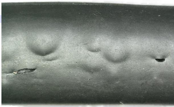
Abb. 5: Schadensbild Luft im Hydrauliköl, die Schädigung findet sich im Gegensatz zur Spaltextrusion auf der Druckseite.
