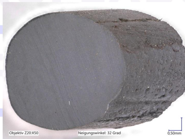
Abb. 11: Oberflächenbeschädigung eines O-Rings durch harte Kavitation an einer nassen Zylinderlaufbuchse
