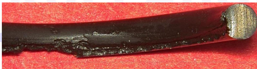
Abb. 5: Schadensbild Luft im Hydrauliköl, die Schädigung findet sich im Gegensatz zur Spaltextrusion auf der Druckseite.
