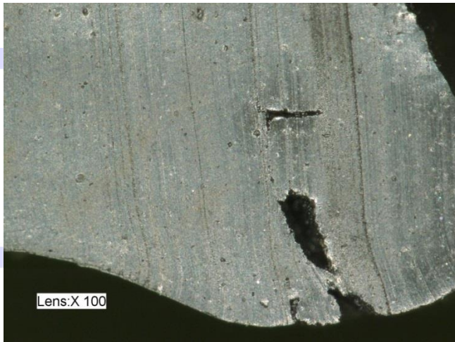
Abb. 4: Querschnitt durch eine geschädigte Hydraulikdichtung: Der Schadensmechanismus der „mikroskopischen“ explosiven Dekompression verursachte kleinere Risse (100-fache Vergrößerung!) im Inneren der Dichtung
