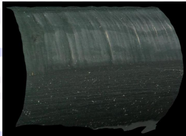
Abb. 13: Geschädigte O-Ring Oberfläche durch Blow-by Effekte infolge harter Druckstöße: Dieses Schadensbild kann einer Strömungserosion ähneln
