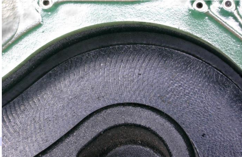
Abb. 3: Ungünstige Oberflächenstruktur an der Dichtfläche eines Kunststoffbauteiles, durch die Riefen kann es zu einem frühzeitigen Überblasen kommen
