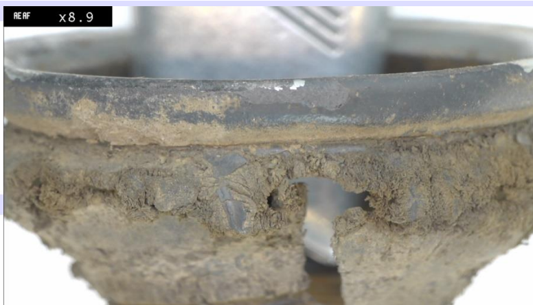
Abb. 14: FEPM O-Ring (Aflas®) nach Einsatz von ca. 5 Jahren in einer Armatur eines Fernwärmenetzes bei Heißwassertemperaturen bis zu 170°C (Dreiecksnut)
