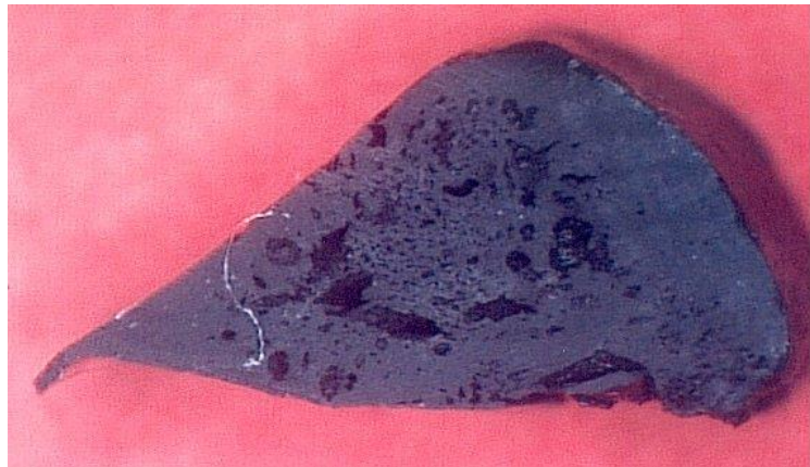
Abb. 14: FEPM O-Ring (Aflas®) nach Einsatz von ca. 5 Jahren in einer Armatur eines Fernwärmenetzes bei Heißwassertemperaturen bis zu 170°C (Dreiecksnut)
