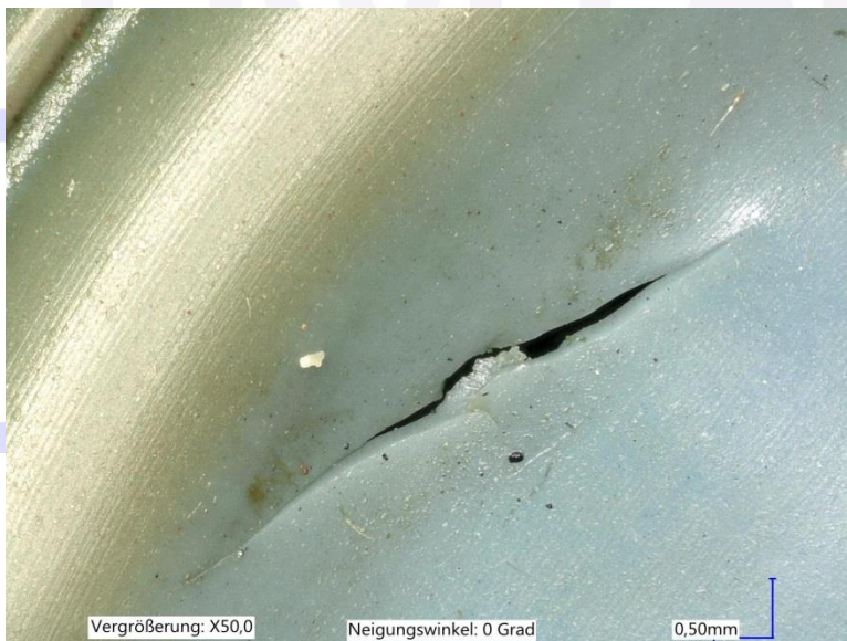
Abb. 5: Einschnitt an einer Membran durch eine scharfe Kante im Einbauraum
