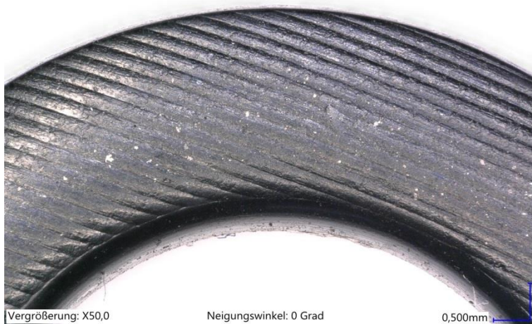
Abb. 7: Dieser Ausfallgrund durch eine ungeeignete Oberflächenstruktur der Nut kann bereits klar im Mikroskop erkannt werden, da sich die schlechte Oberfläche sichtbar auf dem Elastomer abgedrückt hat: Die Leckage entsteht durch die tiefen Riefen in der Nut
