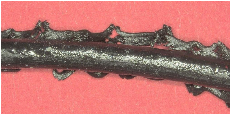
Abb. 2: O-Ring Querschnitt nach einer klassischen Nutüberfüllung: Oben und unten sind die abgequetschten Bereiche zu erkennen
