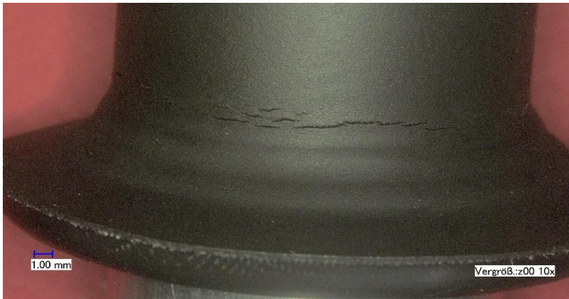
Abb. 7: Hutmembran aus FKM mit Gewebeeinlage mit übermäßig hohen lokalen Verformungen: Die Membran wurde nach der Vulkanisation auf „links“ gestülpt, also von innen nach außen
