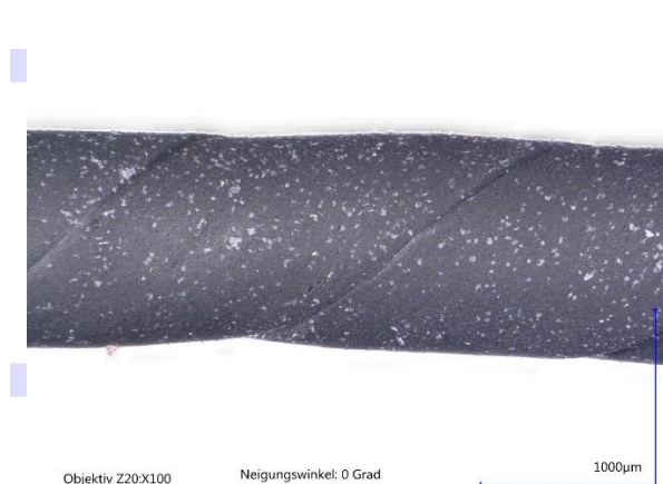
Abb. 2: Künstlich nachgestellte, umlaufende Einschnürung an einem O-Ring wie bei einem Spiralliss; durch Einspannung wird die Verdrillung gehalten
