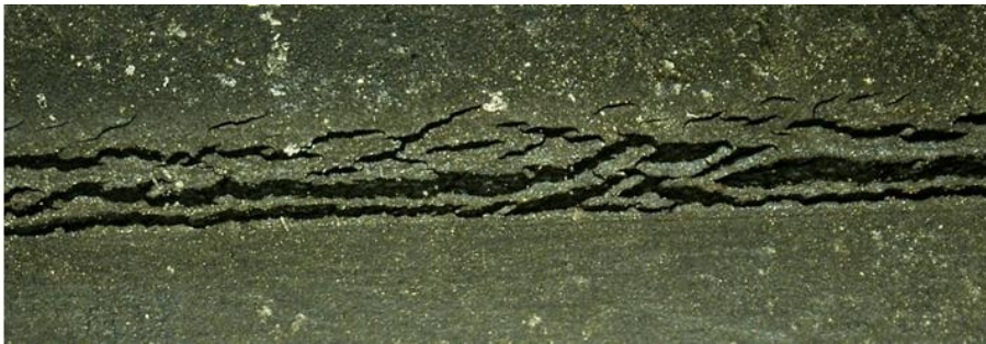
Abb. 9: Ozonrisse an einem statisch vorgedehnten Faltenbalg aus einem BR/IR-Elastomer
