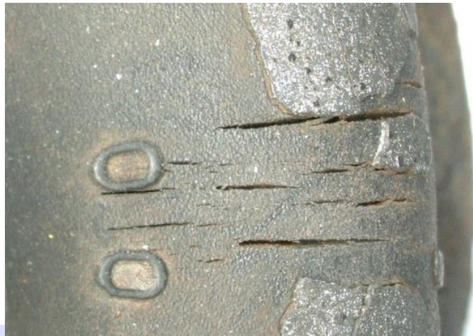
Abb. 4: Fehlerhaft montierte Manschette aus Polyesterurethan (AU) mit Ermüdungsrissen
