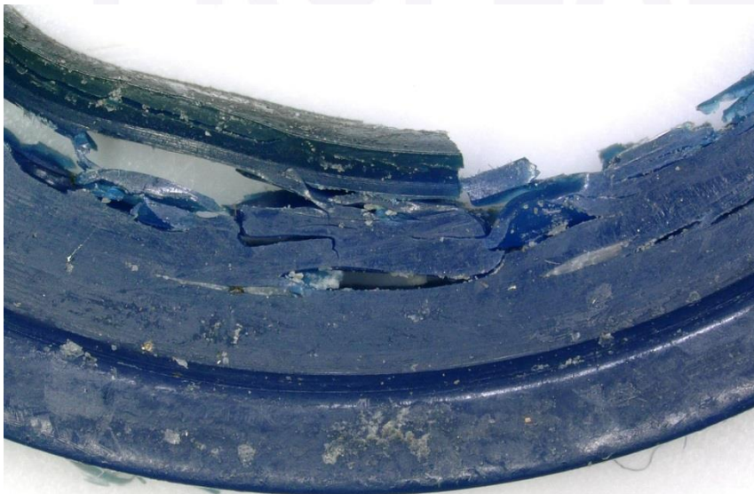
Abb. 4: Hydrolyse (= Chem. Angriff durch Wasser) einer Polyurethandichtung
