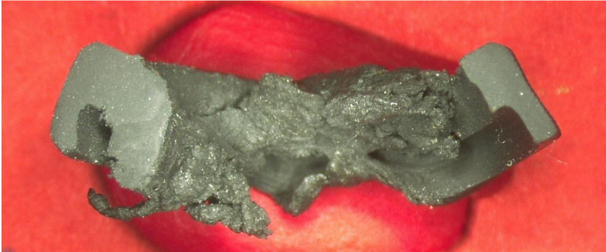
Abb. 1: Stark gequollene EPDM-Dichtung nach einer dynamischen Beanspruchung einer Lipendichtung
