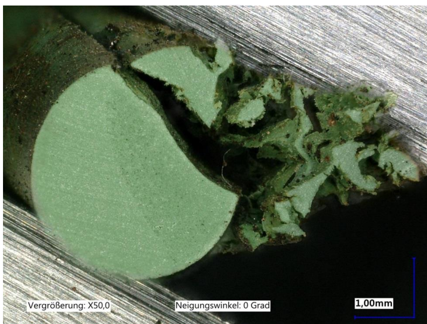
Abb. 6: Starke Quellung und daraus resultierende Abscherung
