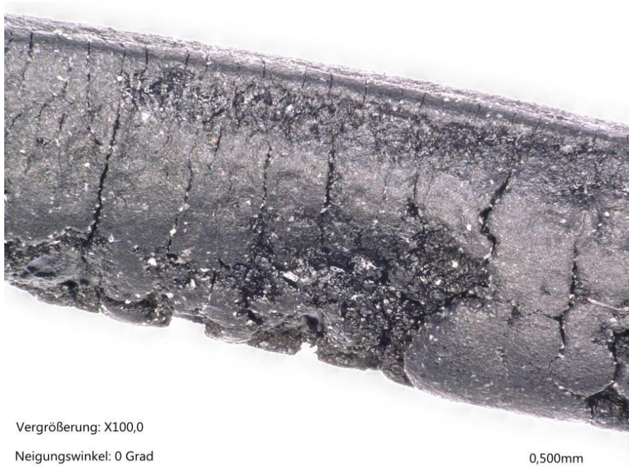
Abb. 2: EPDM O-Ring, peroxidisch vernetzt nach einem Einsatz in einem überwachten Dauerversuch für eine Wasserarmatur (Schadensursache: Entzinkung von Messing, zyklische Temperaturwechsel von 25° C bis 95° C in Wasser, Versuchsdauer 4500 h)
