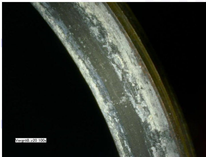
Abb. 7: Gegenfläche des EPDM O-Rings aus Abb. 6, bei den weißen Bereichen handelt es sich vermutlich um Kalkablagerungen
