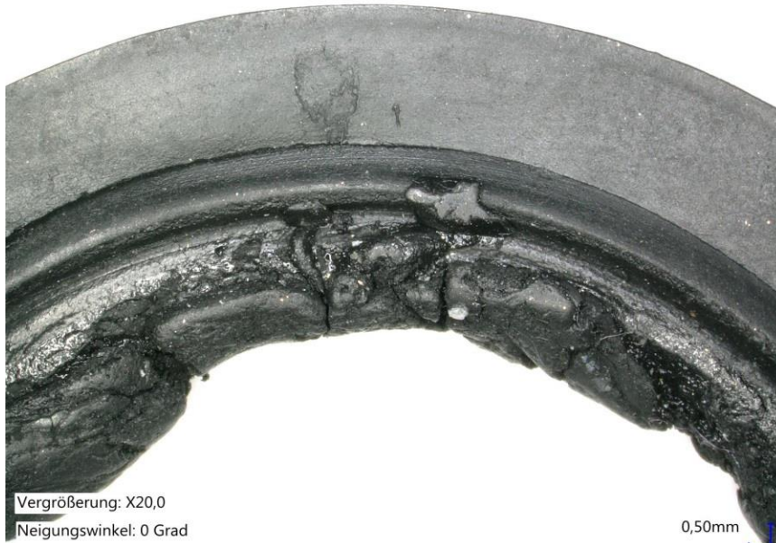
Abb. 4: Ein durch Autoxidation geschädigtes Elastomer (peroxidisch vernetztes EPDM), das im Innenbereich des Dichtringes ganz deutlich aufgeschmolzene Bereiche wie bei einem Thermoplast oder TPE aufweist.
