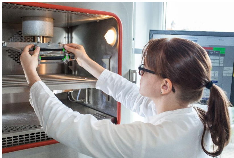
Abb. 2: Einsetzen eines Probekörpers in einen Ozonprüfschrank: Nicht jeder HNBR hat eine gute Ozonbeständigkeit (Bild: Tobias Ehmer)
